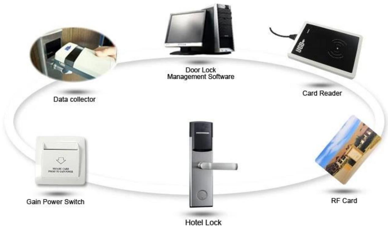
1. [sistema di blocco porta elettroniche per Alberghi](#) Serratura (qty = camera)---per aprire la porta
